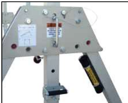
La estructura se opera sin el uso de herramientas y contiene un tubo con instrucciones de operación
