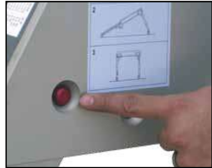
Empuje botón de desbloqueo y bloqueo
