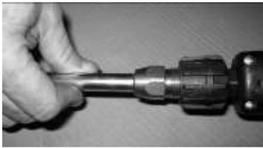
2. Inserte una abrazadera en el otro extremo del tubo moleteado e insértela en la entrada del sifón.
