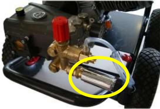
El kit consta de un único componente que se monta como se muestra en la foto de la derecha.
