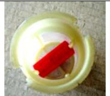
Después de repostar, comprobar que la posición del rojo es la de la imagen, en caso contrario orientar correctamente el filtro de combustible y apretar el tapón al depósito.
