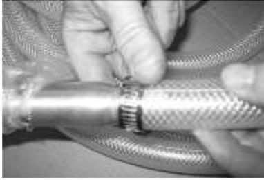
3. Inserte el tubo de metal en la rosca hembra del cabezal de limpieza del tubo y apriételo usando el gallo especial,
