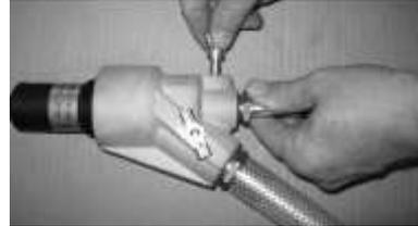
5. Insertar el otro tubo roscado en el racor con andador de lanza, hasta que quede completamente apretado.
